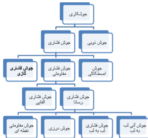
تقسیم بندی انواع روش جوشکاری براساس آیین نامه 1910 DIN
